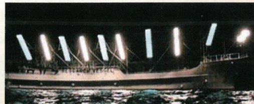
二酸化炭素発生量削減のための青色発光ダイオードを使用したさんま棒受け網漁船
